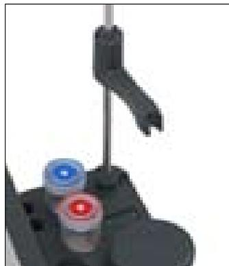
6. 请将电极放置到电极支架上。通过槽穿入电极线缆。
