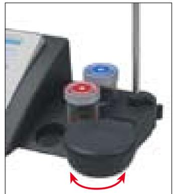
2. 将搅拌器拉出来，并进行更换。将新搅拌器的线缆穿过仪器底部的插槽。
