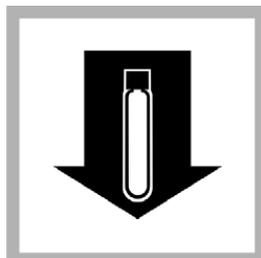
5. 将待测样品插入 16mm 圆形样品池。
