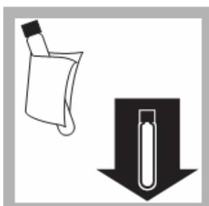
9、擦干净空白试管外壁，放入 DR890 的试管样品架上，并盖上遮光盖。
