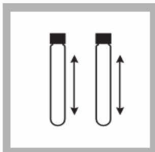
6、拧紧盖子，剧烈摇晃，使粉末溶解。如存在氨将显示绿色。
