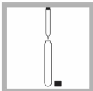
2、准备样品：将 2.0 mL 样品加入到一支装有 Am Ver 稀释液的 TNT 管中（低量程选用 26022-00，高量程选用 26070-00）。
