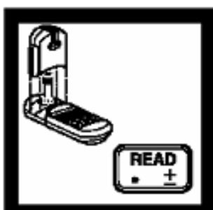
12、按“READ”，屏幕将显示测量结果，单位为：mg/L NH<sub>3</sub>-N<sup>①</sup>。
