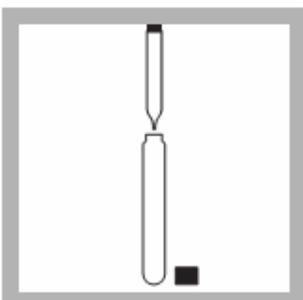
3、准备空白：将 2.0 mL 无氨水加入到一支装有 Am Ver 稀释液的 TNT 管中。
