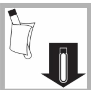
11、擦干净样品试管外壁，放入 DR890 的试管样品架上，并盖上遮光盖。
